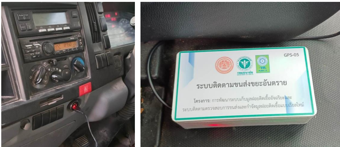
รูปที่ 17 USB ที่จุดบุหรี่ที่มีแหล่งจ่ายไฟดีซีออก 5 โวลต์ กระแสไฟ 2.4 แอมป์
